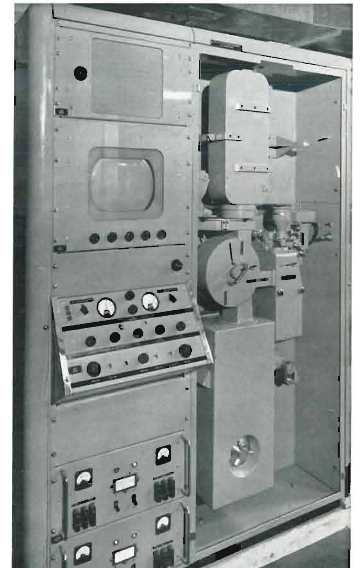
Fig. 2 - Dispositivo per la trasmissione a colori di diapositive a film passo 16 mm.
